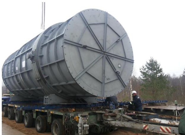
Перемещение груза с помощью «СКАТа»
